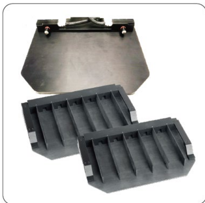
图 17：IVIS 摆位平台（上图）和智能托盘（下图）
